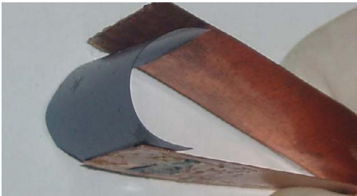
Гибкий электродный материал на основе композита  $V_2O_5 - Ba_6Mn_{24}O_{48}$
