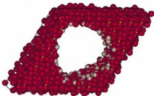
Две стратегии получения пористых систем – путем создания структур с туннелями в кристаллической решетке (цеолит, вверху, каналы 5-50 Å) и создание пор за счет темплатного синтеза (мезопористые оксиды, внизу, поры 5-50 нм).
