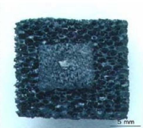
**Сверхпроводящий образец  $YBa_2Cu_3O_z$  с тканевой структурой (слева) после пропитки расплавом и кристаллизации в присутствии четырех ориентированных затравок на воздухе (транспортный ток  $> 10^4$  А/см<sup>2</sup> при 77К). Сверхпроводящая пена после подобной же обработки (справа).**
