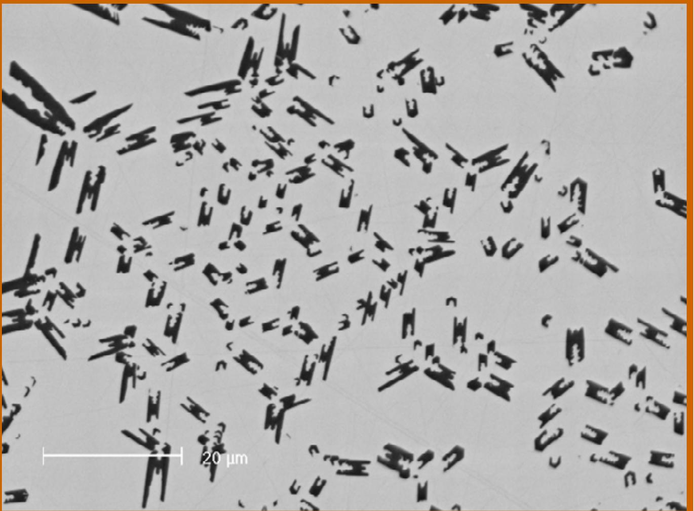
Закалка расплава с высокой температуры в стеклообразное состояние.
