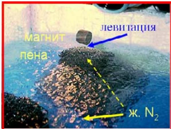
**Левитация магнита над охлаждаемой жидким азотом пенокерамикой ВТСП.**
