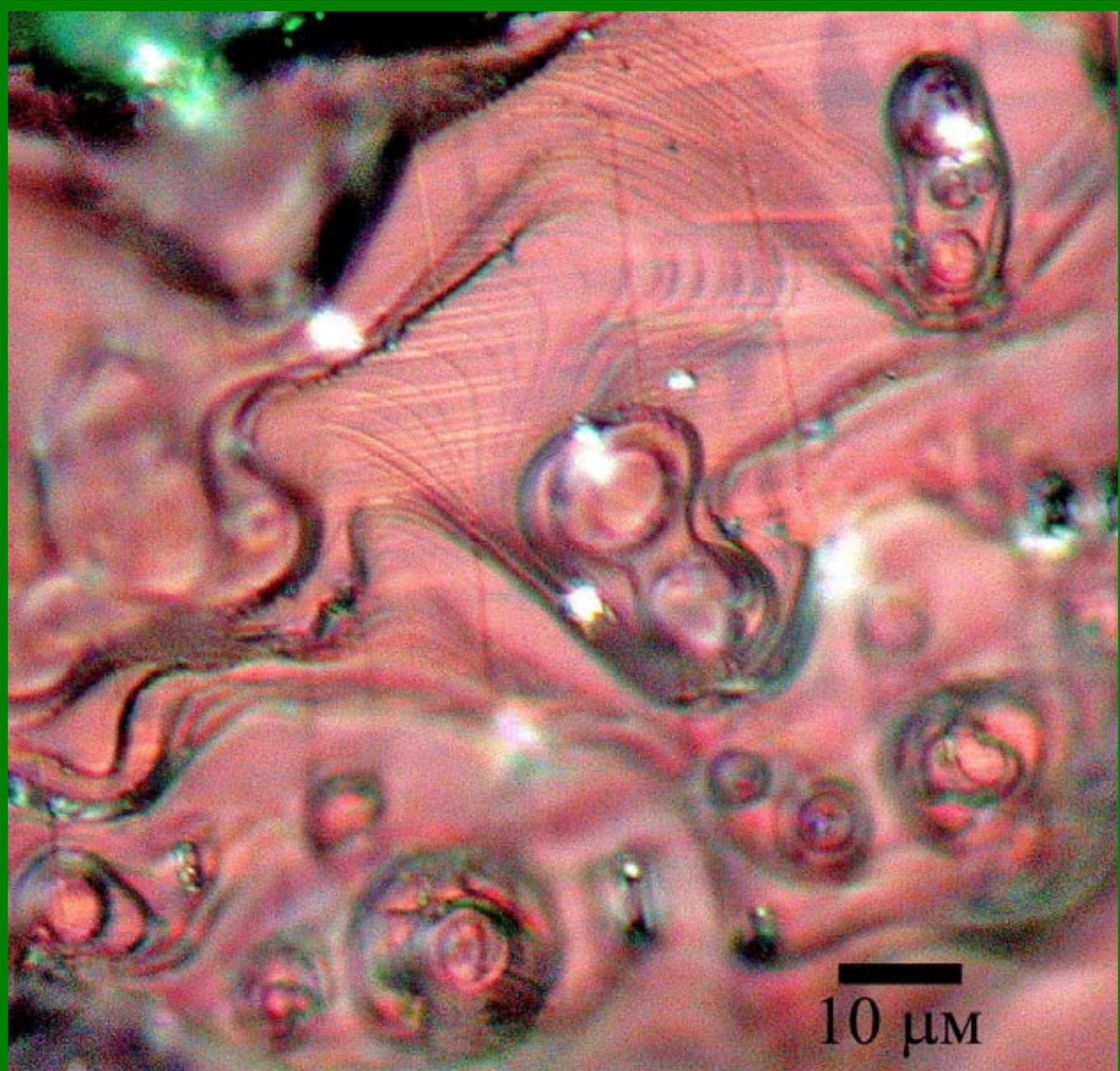
**«Проблемы роста».** Ростовая микроморфология прожилок пенокерамики (оптическая микроскопия в поляризованном свете). Видны островки роста на поверхности пенокерамики, а также эшелоны ступеней роста. Образец не шлифован и сохраняет естественные неровности поверхности, в которых «записана» история кристаллизации образца.
