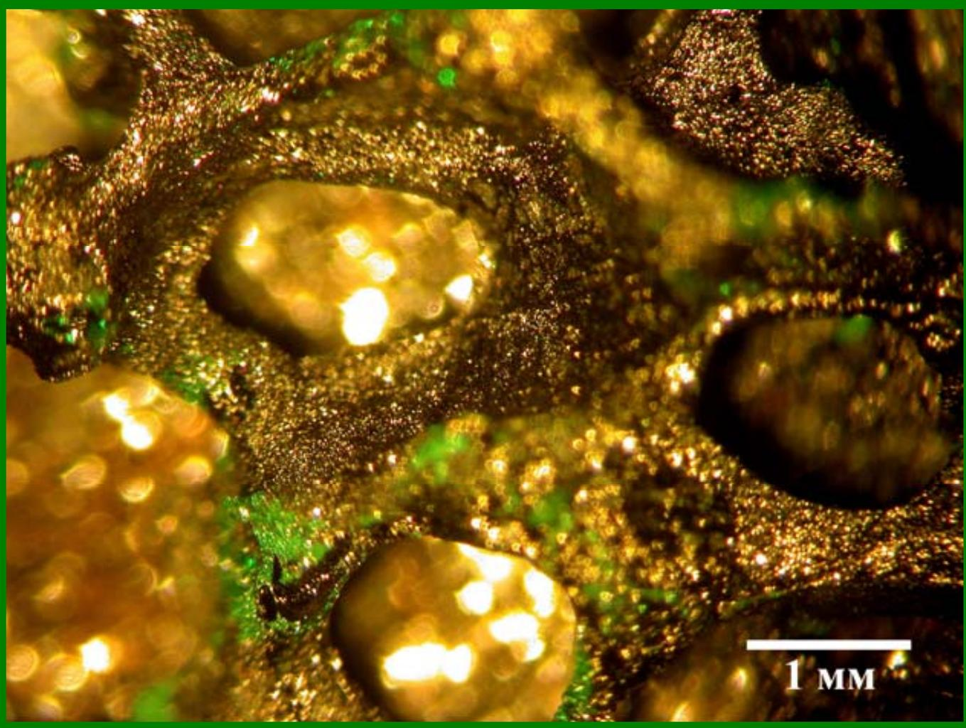
**«Сверхпроводящая мозаика».** Иерархическая дефектная структура сверхпроводящей (ВТСП) пенокерамики на основе иттрий - бариевого купрата  $\text{YBa}_2\text{Cu}_3\text{O}_x$ . (оптическая микроскопия в поляризованном свете на шлифе образца, последовательная полировка вплоть до размеров зерна абразива 0.5 микрон). Данная фотография представляет большой методический интерес, поскольку наглядно демонстрирует сложную реальную структуру современных
