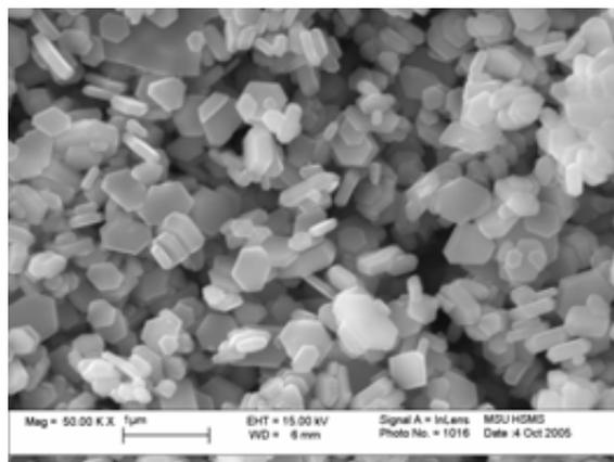
Порошок, состоящий из монокристаллических частиц гексаферрита стронция, легированного алюминием. Получен растворением в разбавленной соляной кислоте стеклокерамического композита, характеризующегося рекордной коэрцитивной силой. Перспективный материал для изготовления постоянных магнитов.
