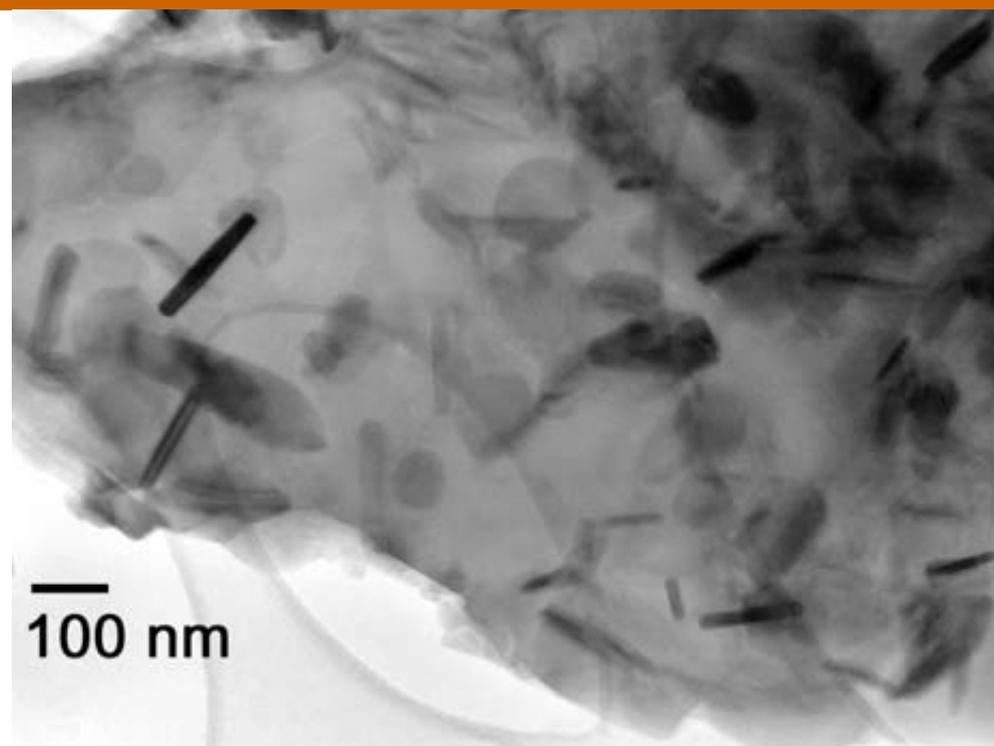
Магнитный нанокompозит на основе гексаферрита стронция, перспективный для создания носителей информации с высокой плотностью записи. Однодоменные частицы гексаферрита стронция находятся в матрице силиката стронция.
