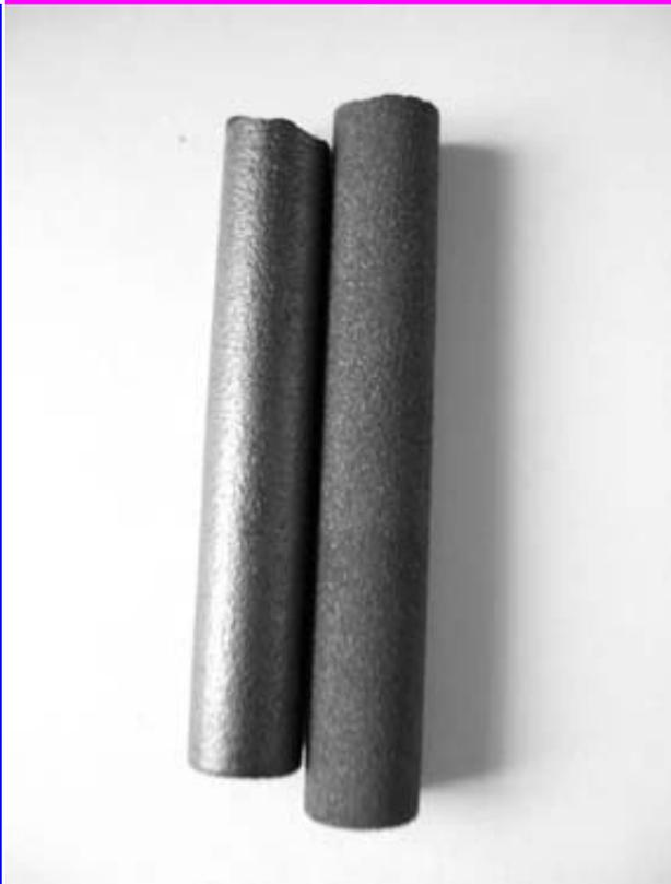
Альтернативная технология – тонкостенную керамическую трубку («папиросная бумага»), полученную шликерным литьем и магнитно-импульсным прессованием с последующей термообработкой (слева) подвергают поверхностному плавлению и кристаллизации пучком лазера для получения химически и физически совместимого с материалом трубки поверхностного слоя – газоплотной пленки (верхняя фотография).
