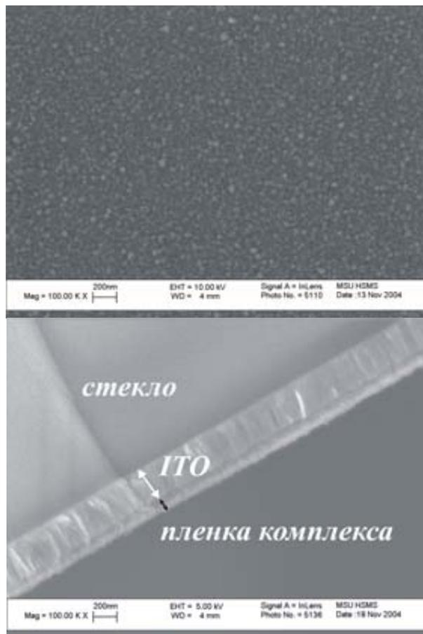
**Пленка ЭЛ материала.** Микрофотография пленки разнолигандного комплекса тербия –  $Tb(Sal)_3(TOPO)_2$  (HSal – салициловая кислота, TOPO – три(н-октил)фосфиноксид), полученной методом центрифугирования на подложке стекло/ITO, толщина пленки ~70 нм, источник зеленого света.
