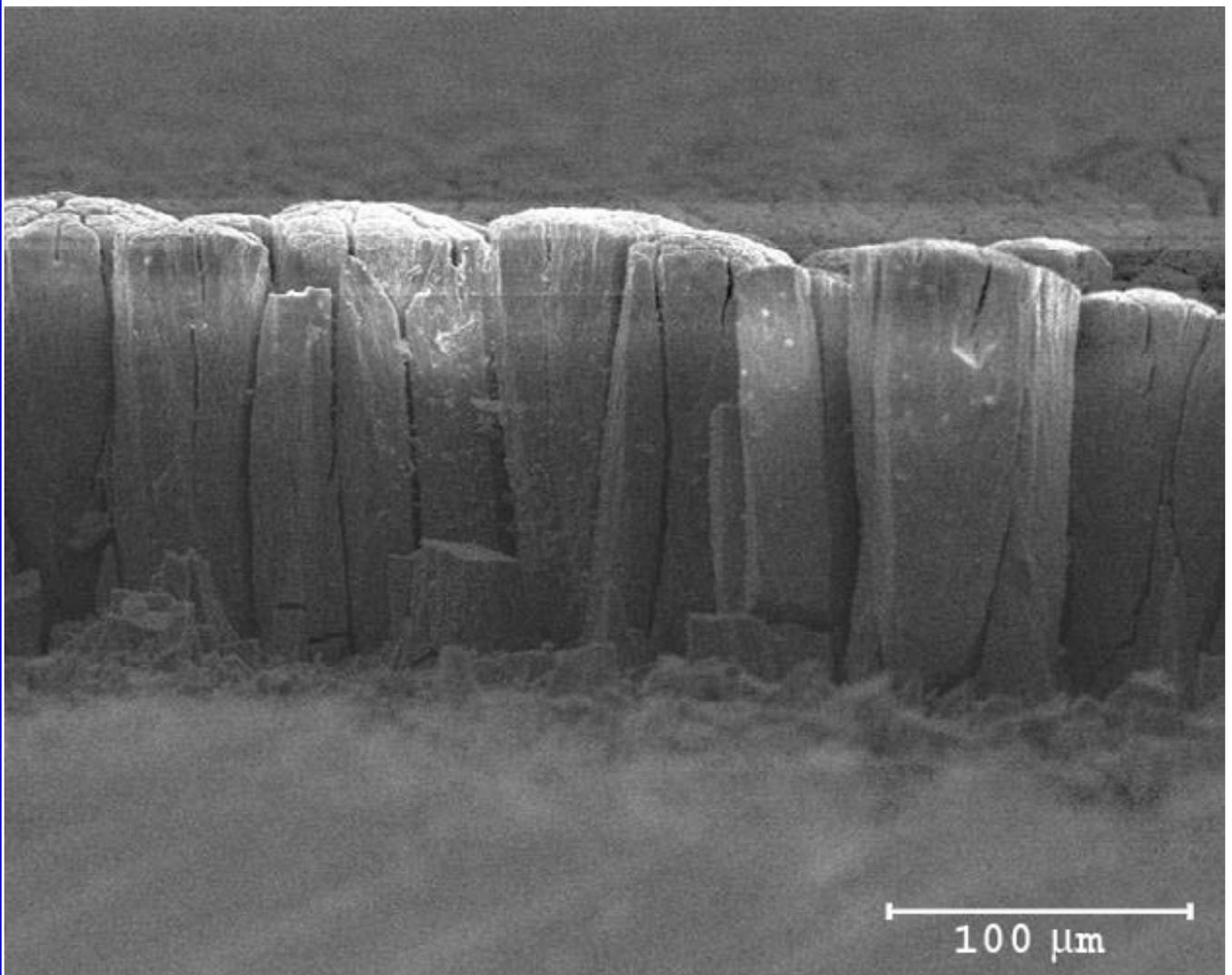
Поперечный срез образца из никелевого суперсплава с теплозащитным покрытием  $ZrO_2$ , стабилизированного  $Y_2O_3$ . На изображении видна колончатая микроморфология покрытия, обеспечивающая его высокие эксплуатационные характеристики.
