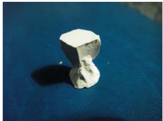
Образец биоцемента после механических испытаний
