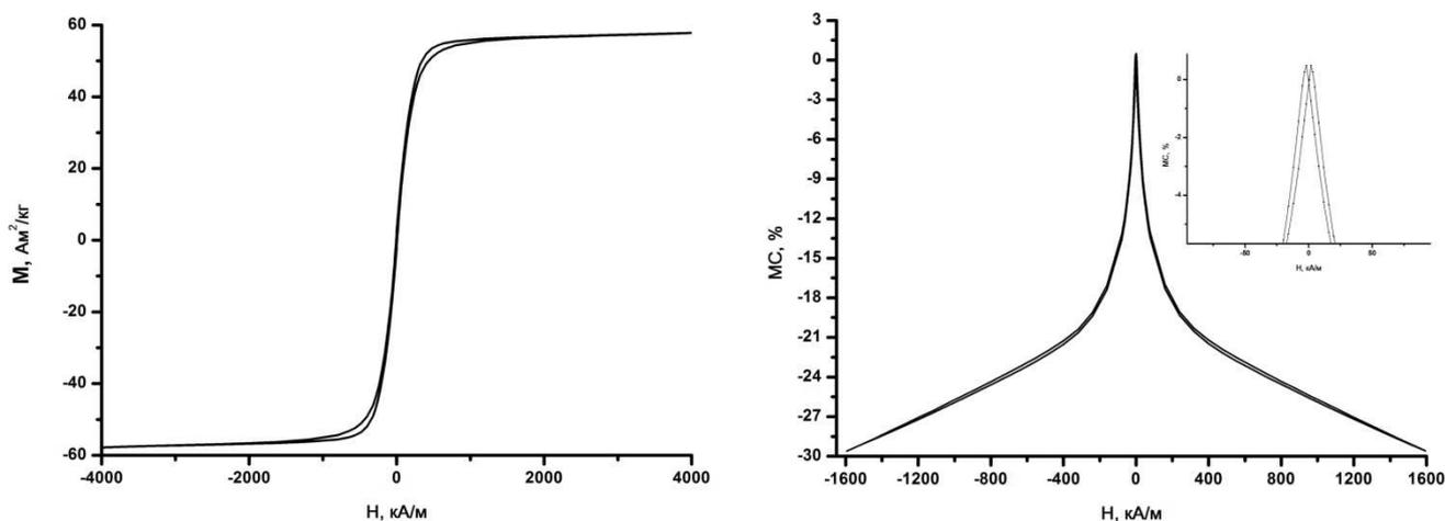
**Рис. 12.** Петля гистерезиса (слева) и полевая зависимость магнитосопротивления (справа) при 10 К для стеклокерамики состава  $18 \{3La_{0,7}Sr_{0,3}MnO_{3-\delta} \cdot (MnO_x + 2SrB_2O_4)\}$  950°C.
