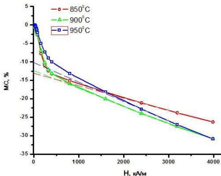
Рис. 5. Полевые зависимости магнитосопротивления стеклокерамики состава 8 в серии отжигов от 850 до 950°C при 77 К. На врезке низкополевая область.
