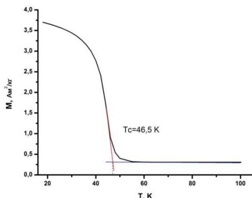
**Рис. 10** Температурная зависимость намагниченности стеклокерамики состава 18,  $900^\circ\text{C}$  ( $H = 8 \text{ кА/м}$ ).
