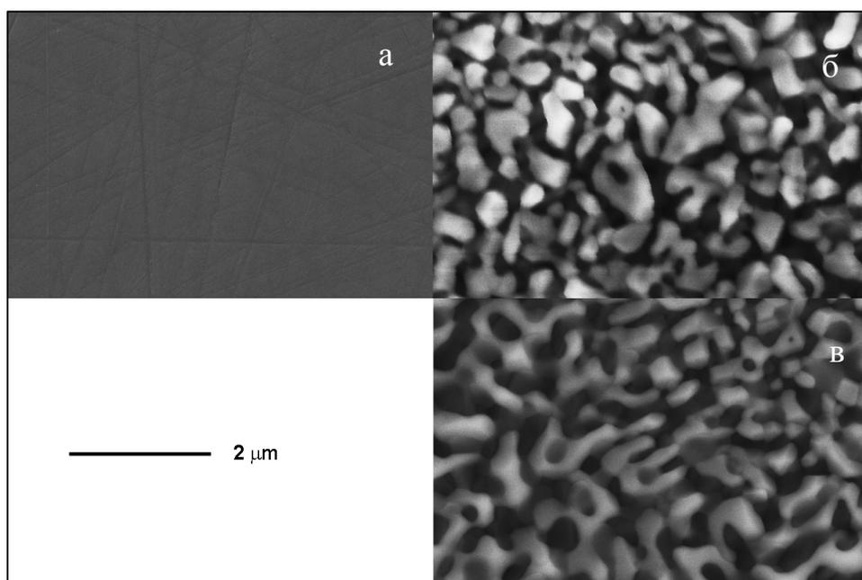
**Рис. 3.** Микрофотографии (РЭМ) образцов исходного стекла состава 8 (а) и стеклокерамики, полученной отжигом при 900 (б) и 950 (в). Светлые частицы – манганит лантана-стронция, тёмные области – боратной матрица.
