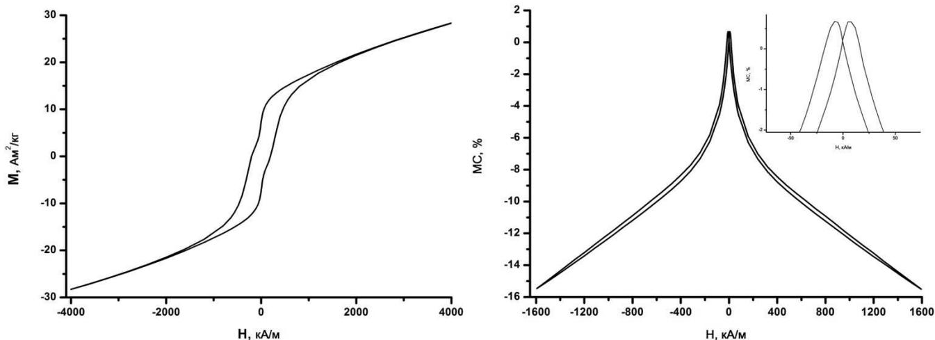
**Рис. 11.** Петля гистерезиса (слева) и полевая зависимость магнитосопротивления (справа) при 10 К для стеклокерамики номинального состава  $\{3\text{La}_{0,7}\text{Sr}_{0,3}\text{MnO}_{3-\delta} \cdot (\text{MnO}_x + 2\text{SrB}_2\text{O}_4)\}$   $900^\circ\text{C}$ .
