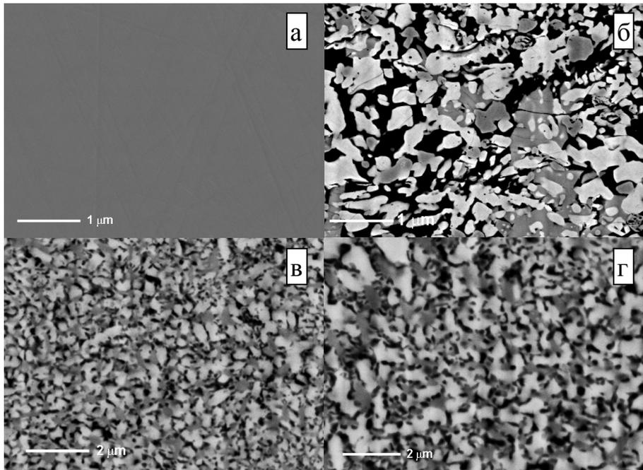
**Рис. 8.** Микрофотографии образцов состава  $\text{La}_{0.7}\text{Sr}_{0.3}\text{MnO}_{3-\delta} + 2(2\text{LaVO}_3 + \text{SrB}_2\text{O}_4)$ : аморфизованного (а), полученных отжигами при 800 (б), 900 (в), 950 (г).
