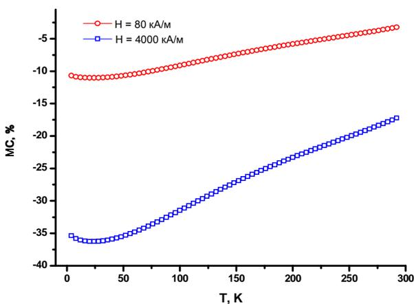
**Рис 9.** Магнитосопротивление стеклокерамики
