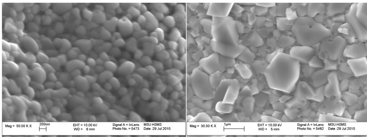
**Рис. 13.** Микрофотографии сколов стеклокерамики состава  $18 \{3La_{0,7}Sr_{0,3}MnO_3 \cdot (MnO_x + 2SrB_2O_4)\}$  900°C (слева) и 950°C (справа).
